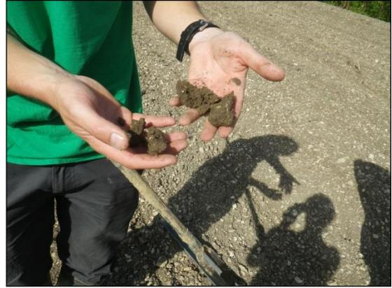
*Exemple de réalisation d'un sondage pédologique à la tarière à main et observation visuelle du carottage*
